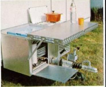
Coffre sur flèche en duralinox permettant l'équipement d'un réfrigérateur; la cuisine sous l'avant et le pique-nique.
