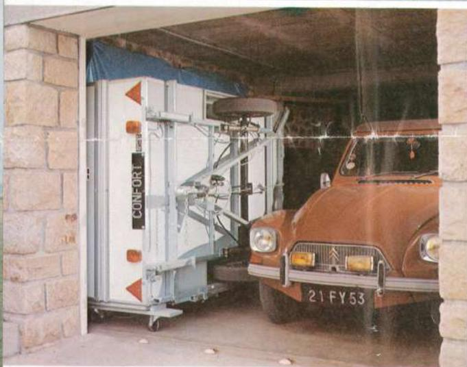
Basculée sur le côté, sur un chariot de remisage, elle se roule au fond de votre garage et n'occupe que 2 m<sup>2</sup> au sol.
