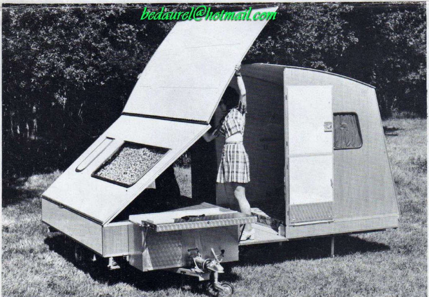
Photo 8 — Le montage se fait face au vent, c'est-à-dire côté table ou côté banquette. Procédé inverse pour le démontage.
