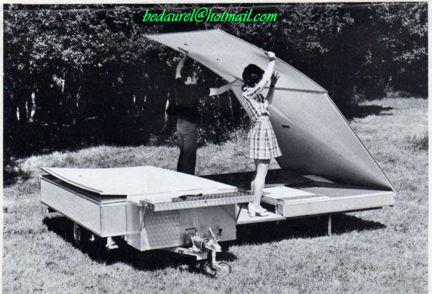
Photo 4 — En ayant l'autre main sous l'embout, élever le toit jusqu'à son emplacement.
