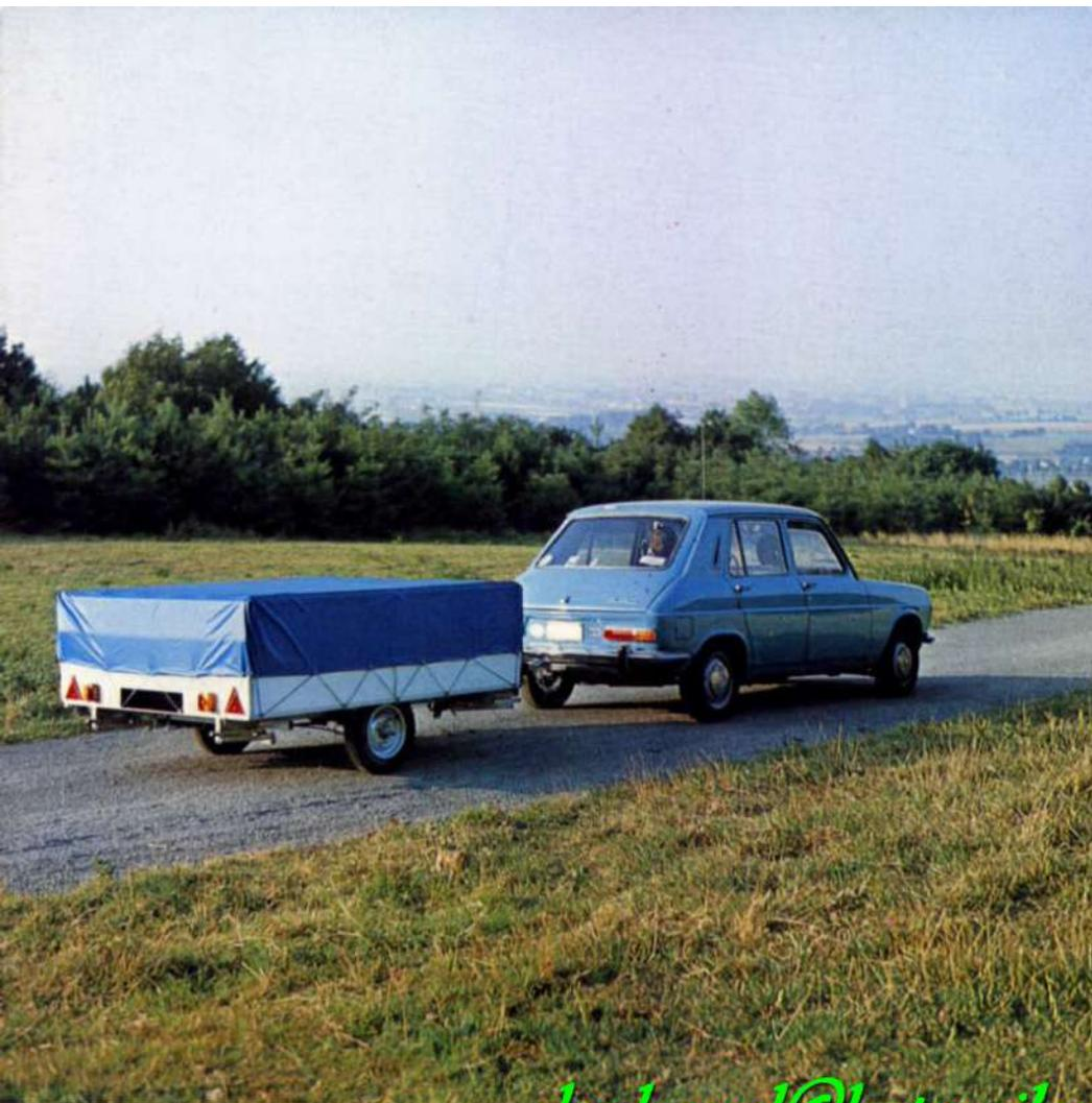
Avec une Rapido derrière votre voiture (grande ou petite), vous roulez décontracté, sans danger de dérapage, avec vue parfaite arrière. Sans aucun problème de circulation, Rapido est montée sur des amortisseurs, et munie de barres de torsion et de timon repliable. Toutes ces pièces sont en matières anti-rouille.
